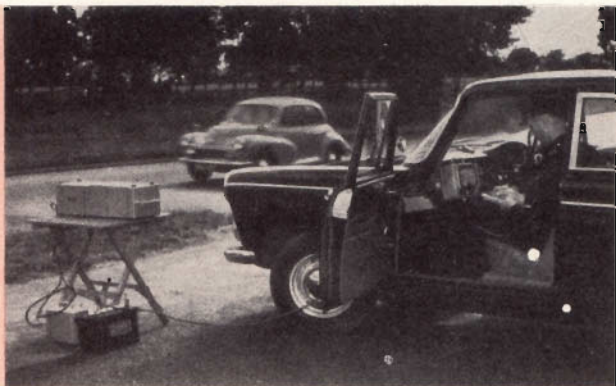
Fig. 1 - L'apparecchio « PETA » in funzione per l'analisi statica delle velocità delle automobili.
